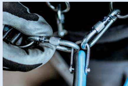
Carabiniera de pe coarda trebuie protejată împotriva deschiderii cu un inel de siguranță cu filet.
