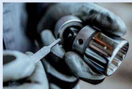
Când montați capete sau extensii, asigurați-vă că orificiul din priză și știftul de pe unitatea pătrată sunt aliniate. Utilizarea dispozitivului de îndepărtare a capetelor tubulare (articolul 1111) apasă știftul în timp ce atașează tubularea. Asigurați-vă că știftul face clic în gaură.
