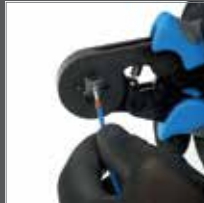
Autoreglat automat la dimensiunea ceruta a firului
