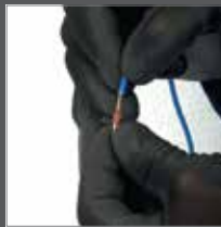
Autoreglat automat la dimensiunea ceruta a firului
