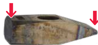
TRATAMENT TERMIC PRIN INDUCTIE PE CAPETE
