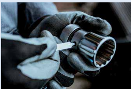
Utilizând dispozitivul de îndepărtare a capetelor tubulare (articolul 1111), apăsați știftul din gaură în timp ce scoateți priza de la unitatea pătrată a clichetului și apoi schimbați tubularea sau extensia.
