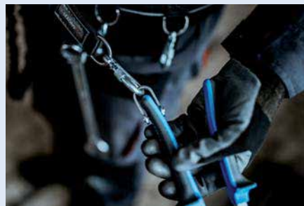
Fixarea corectă a sculei pe coarda. Întoarceți instrumentul la centură urmând pașii în ordine inversă.
