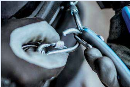
Carabiniera de pe coarda este atașată de inel pe instrument. Inelele pot accepta 2 carabiniere.
