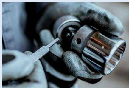
Când montați capete sau extensii, asigurați-vă că orificiul din priză și știftul de pe unitatea pătrată sunt aliniați. Utilizarea dispozitivului de îndepărtare a capetelor tubulare (articolul 1111) apasă știftul în timp ce atașează tubularea. Asigurați-vă că știftul face clic în gaură.
