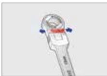
Clichet: functioneaza in ambele sensuri, sensul de rotatie poate fi schimbat cu butonul.
